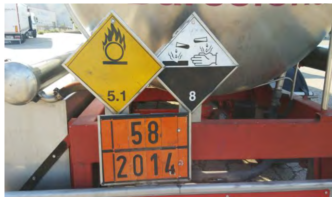
Identificación del peróxido de hidrógeno (panel naranja y etiquetas de peligro) en cisternas según ADR
