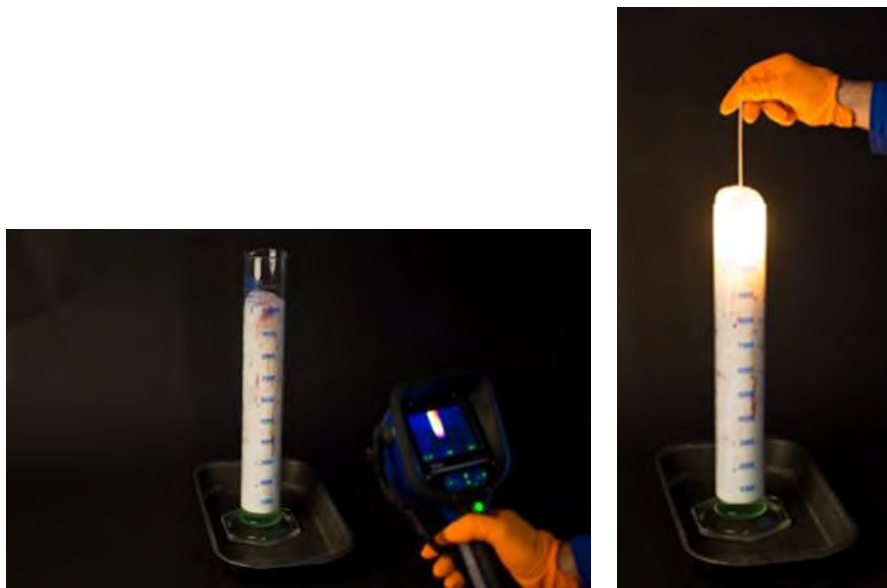
Verificación de incremento de temperatura y la composición de las burbujas
