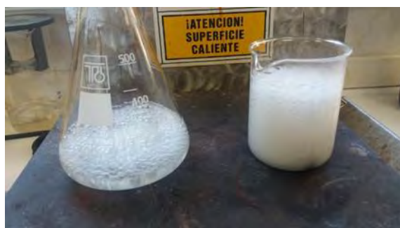
Descomposición del agua oxigenada por calentamiento
